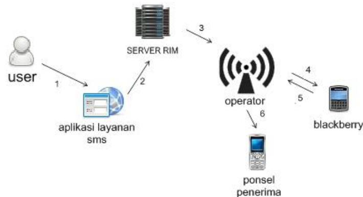
**Gambar 3.1** Alur Utama pada Sistem Layanan SMS Menggunakan Blackberry
