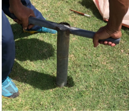
Gambar 5.5 Pengambilan Sampel Tanah Permeabilitas
