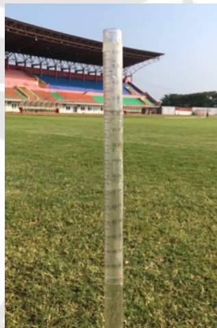
Gambar 5.3 Pengujian Infiltrasi di Lapangan
