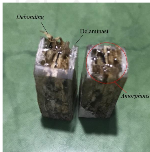
Gambar 4-5 Kegagalan pada spesimen A
