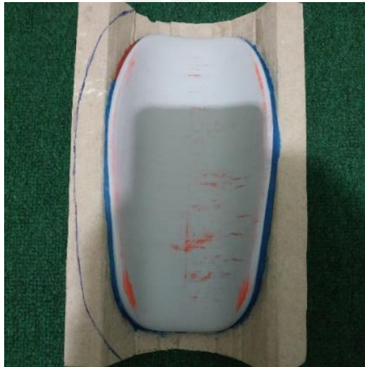
Gambar 4-16 Proses memberi pinggiran pada master cetakan
