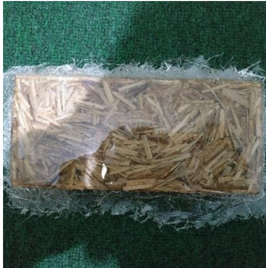
Gambar 3-14 Core Komposit sandwich yang sudah dilapisi skin fiberglass
