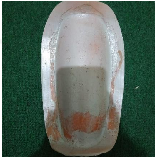
Gambar 4-18 Hasil pembuatan cetakan kedua
