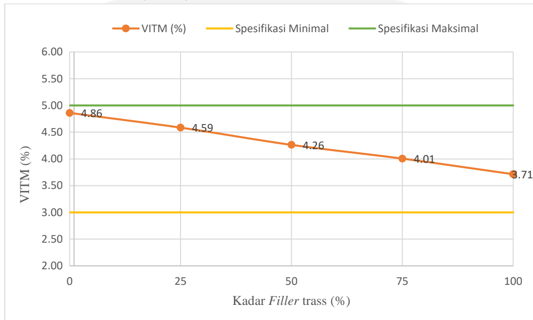
Gambar 5.16 Grafik Pengaruh Batu Trass Sebagai Substitusi Filler Terhadap Nilai Void In Total Mix (VITM)
