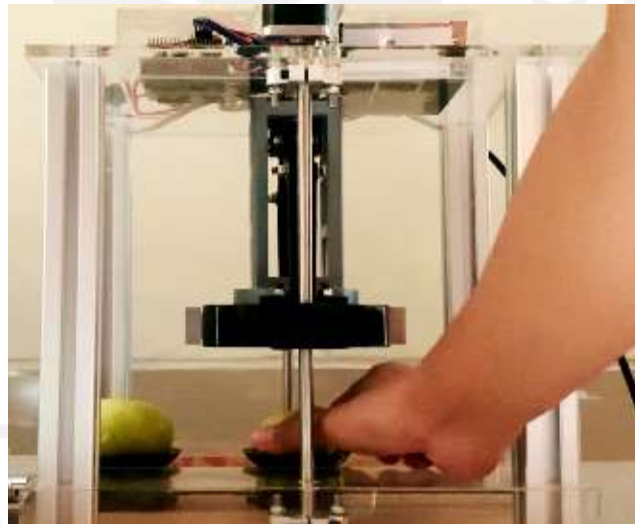
Gambar 4.16 Meletakkan Bawang Bombay pada Holder
