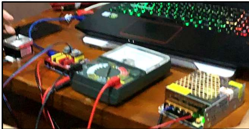
Gambar 4.11 Cek Arus Terhadap Rangkaian Elektrikal
