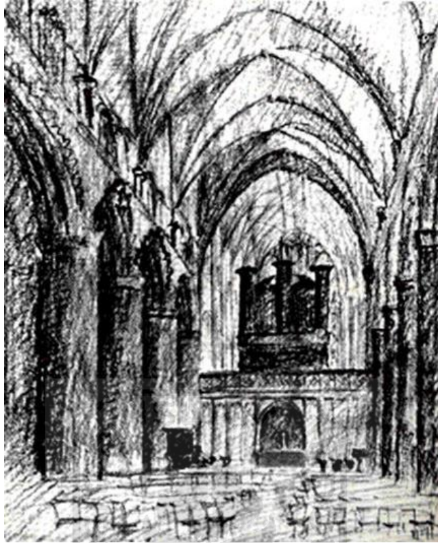
Gambar 2.7 Gambar sketsa J.M. Waldram, merupakan studi analisa tata cahaya yang digunakannya sebagai dasar penentuan perletakan titik lampu. (Santen, van Christa & Hansen, A.J., 1985 : 144.)
