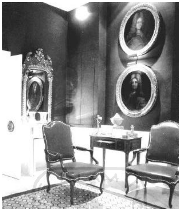
Gambar 2.8 Sebuah contoh penonjolan obyek di sudut ruang dengan teknik pencahayaan buatan dari arah atas (uplighters) dan bawah (downlighters) disertai refleksi dari plafon yang berwarna terang dan dinding berwarna gelap membuat obyek yang ditonjolkan menjadi semakin menarik dengan nuansa gelapterangnya. Hal demikian tidak bisa dilakukan dengan teknik pencahayaan alam. (Niese wand, Nonie, 1999 : 67)
