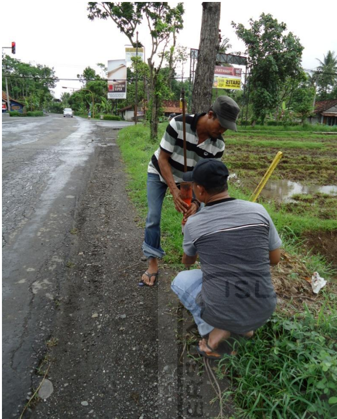
Gambar 7. Pengambilan Data CBR dengan Alat DCP.
