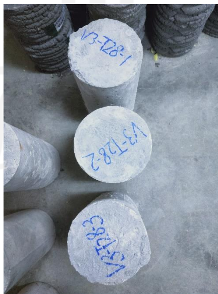
Gambar L-4.4.5 Sebelum Pengujian Kuat Tarik
