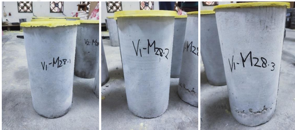
Gambar L-4.2.9 Sebelum Pengujian Modulus Elastisitas
