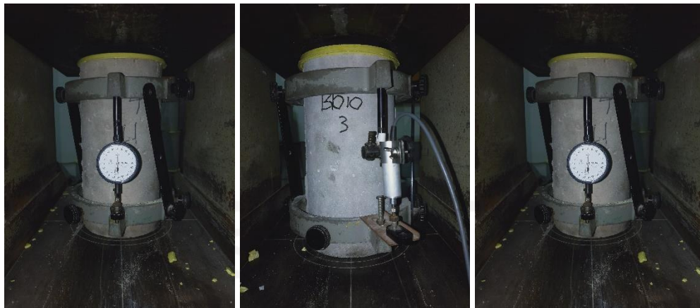
Gambar L-4.1.9 Sebelum Pengujian Modulus Elastisitas
