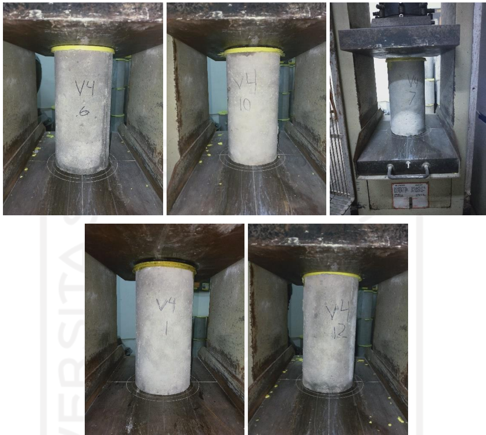
Gambar L-4.1.3 Sebelum Pengujian Kuat Tekan Umur 28 Hari
