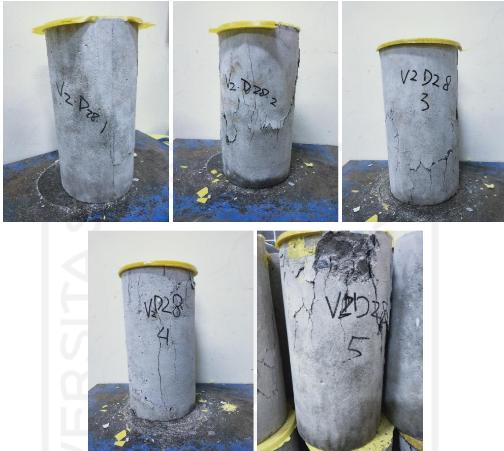
Gambar L-4.3.4 Hasil Pengujian Kuat Tekan Umur 28 Hari
