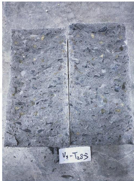
Gambar L-3.9 Hasil Pengujian Kuat Tarik Beton
