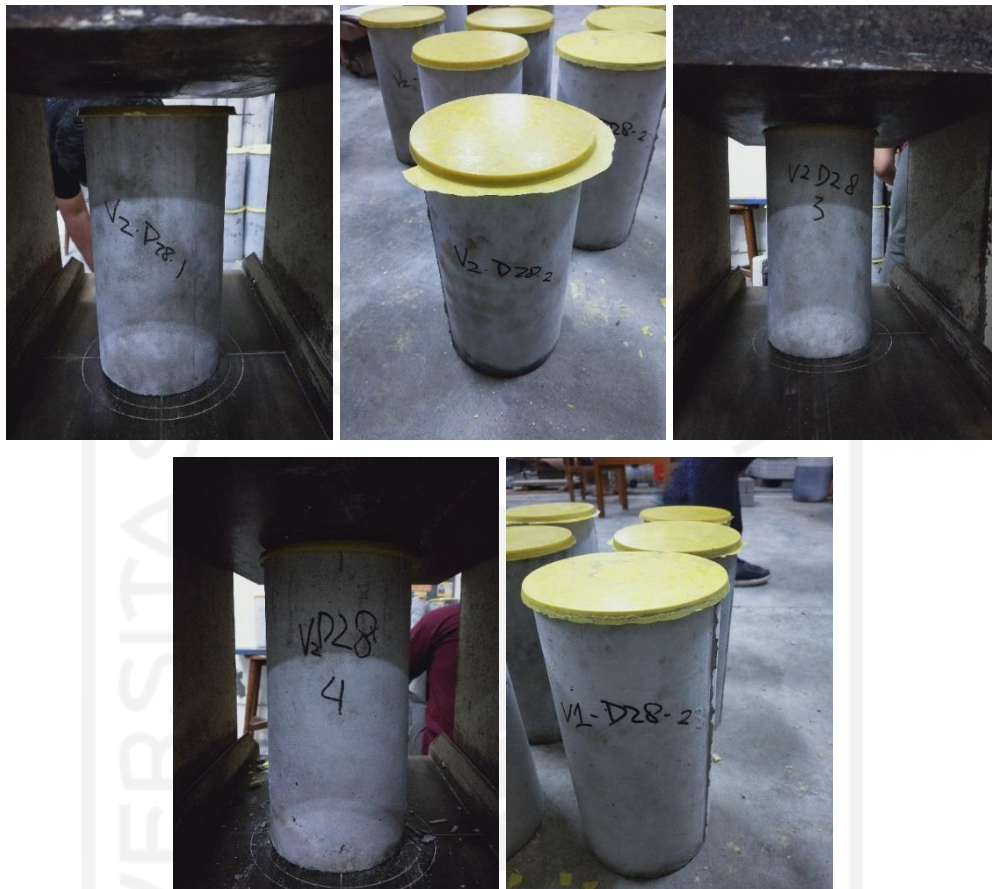
Gambar L-4.3.3 Sebelum Pengujian Kuat Tekan Umur 28 Hari
