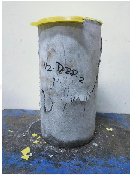
Gambar L-3.5 Hasil Pengujian Kuat Tekan Beton
