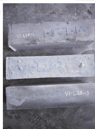
Gambar L-4.2.7 Sebelum Pengujian Kuat Lentur
