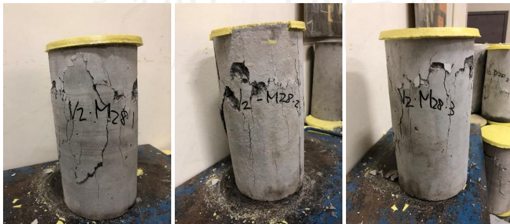
Gambar L-4.3.10 Hasil Pengujian Modulus Elastisitas
