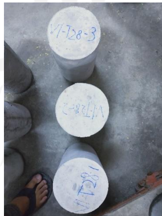
Gambar L-4.3.5 Sebelum Pengujian Kuat Tarik
