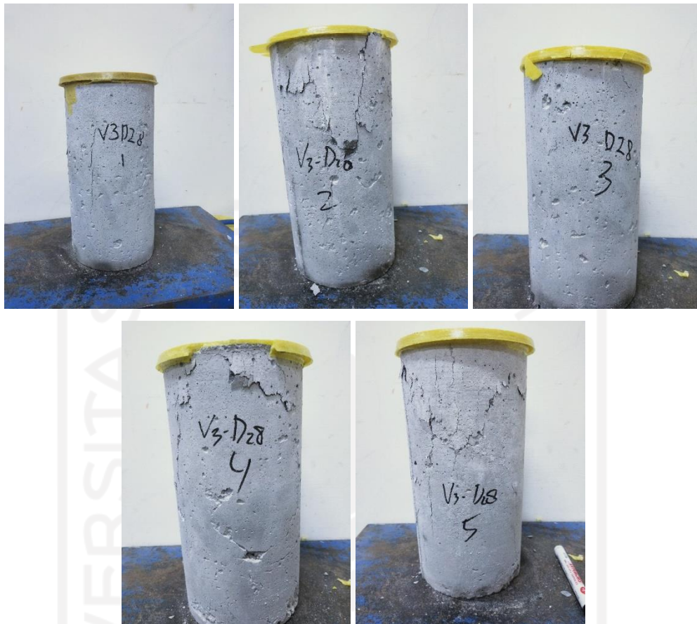
Gambar L-4.4.4 Hasil Pengujian Kuat Tekan Umur 28 Hari
