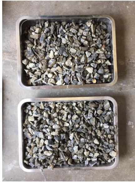
Gambar L-2.3 Agregat Kasar Ukuran 20 mm dari Clereng, Kulon Progo
