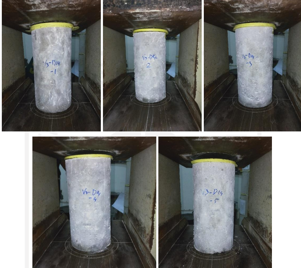
Gambar L-4.4.1 Sebelum Pengujian Kuat Tekan Umur 14 Hari
