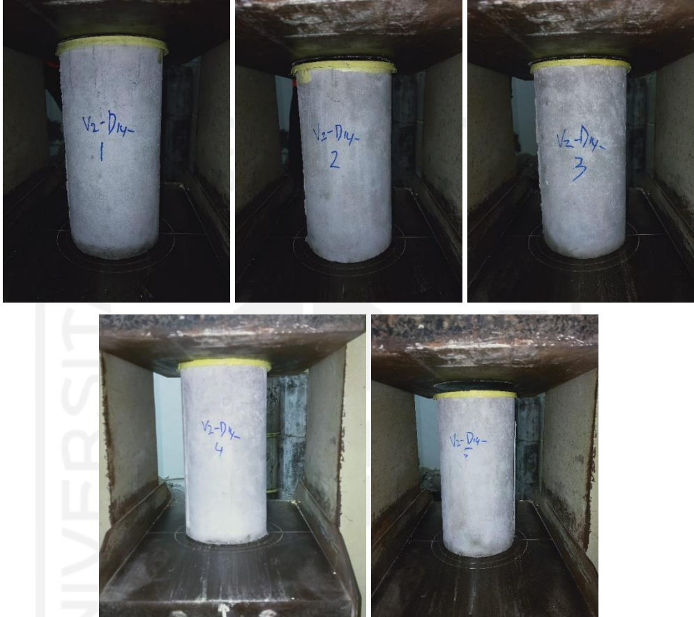
Gambar L-4.3.1 Sebelum Pengujian Kuat Tekan Umur 14 Hari
