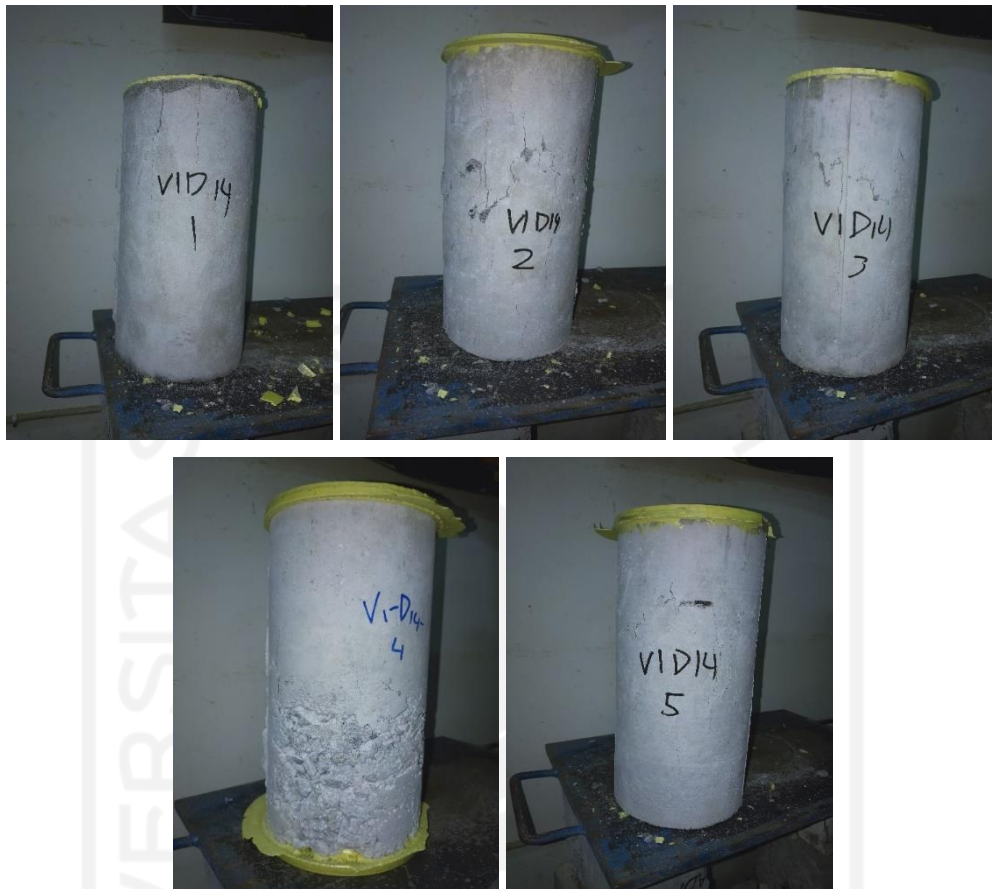
Gambar L-4.2.2 Hasil Pengujian Kuat Tekan Umur 14 Hari
