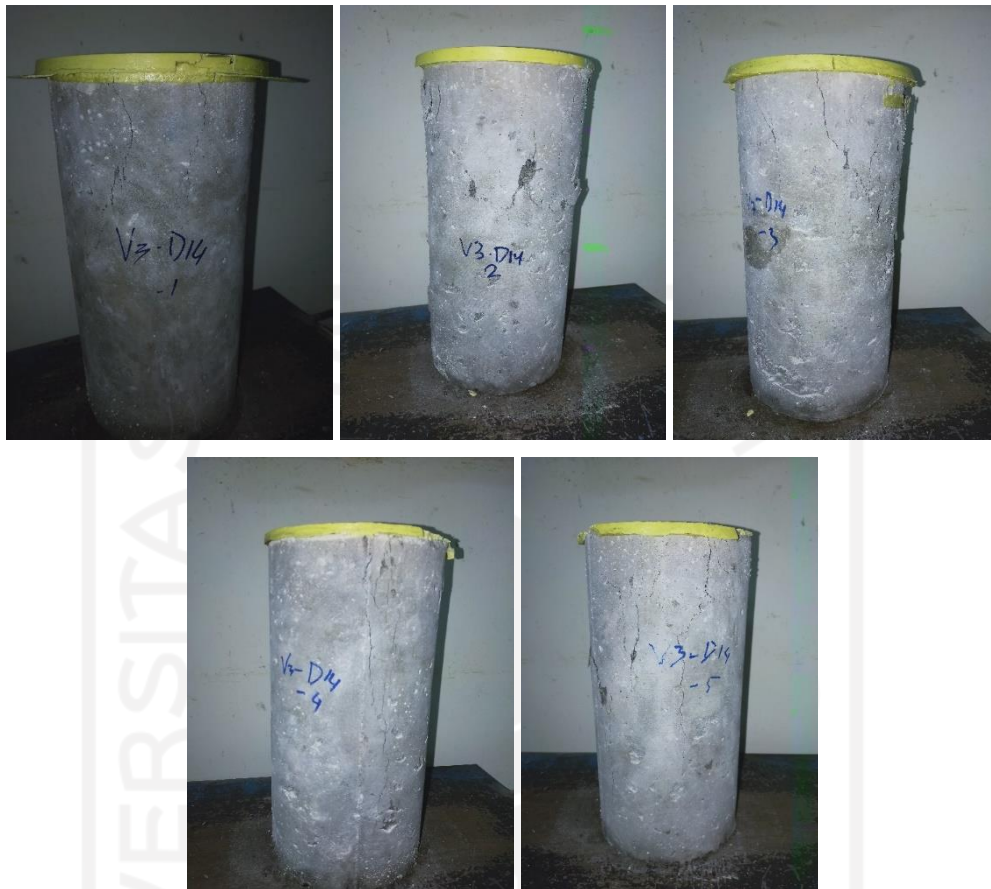
Gambar L-4.4.2 Hasil Pengujian Kuat Tekan Umur 14 Hari
