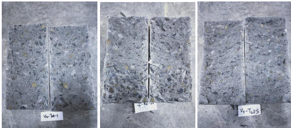
Gambar L-4.4.6 Hasil Pengujian Kuat Tarik
