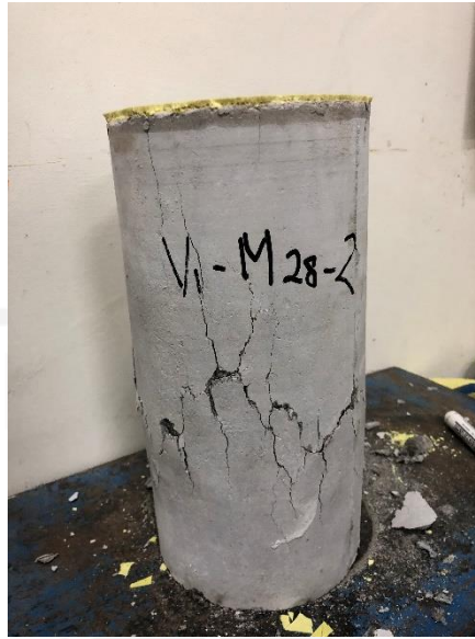
Gambar L-3.7 Hasil Pengujian Modulus Elastisitas Beton
