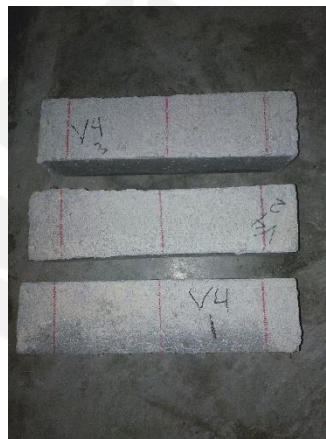
Gambar L-4.1.7 Sebelum Pengujian Kuat Lentur
