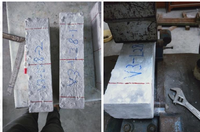
Gambar L-4.4.7 Sebelum Pengujian Kuat Lentur
