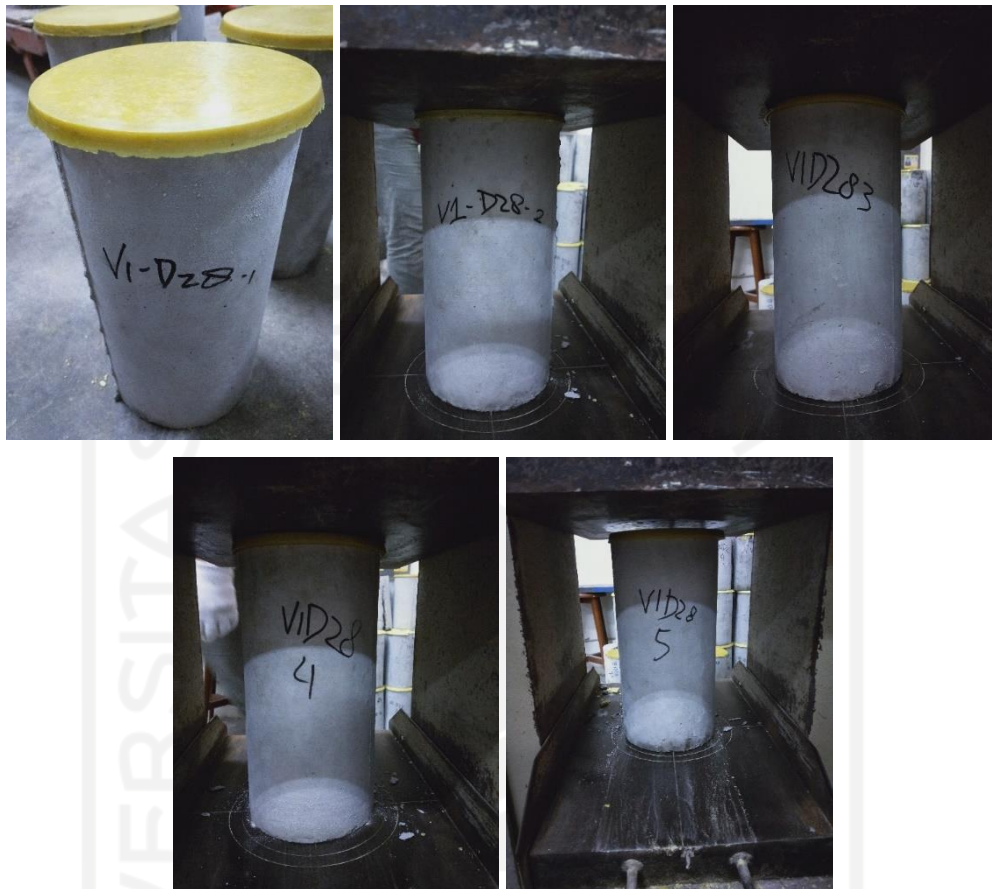
Gambar L-4.2.3 Sebelum Pengujian Kuat Tekan Umur 28 Hari
