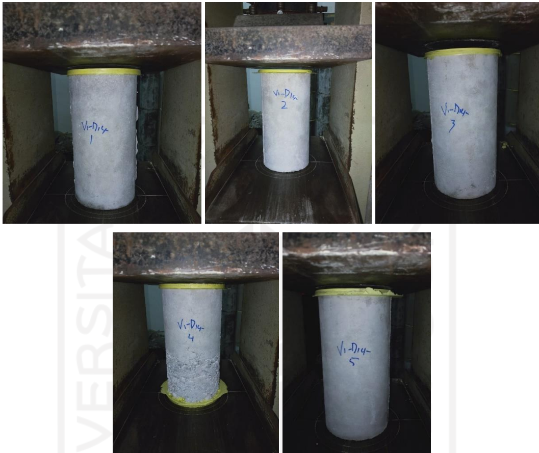
Gambar L-4.2.1 Sebelum Pengujian Kuat Tekan Umur 14 Hari
