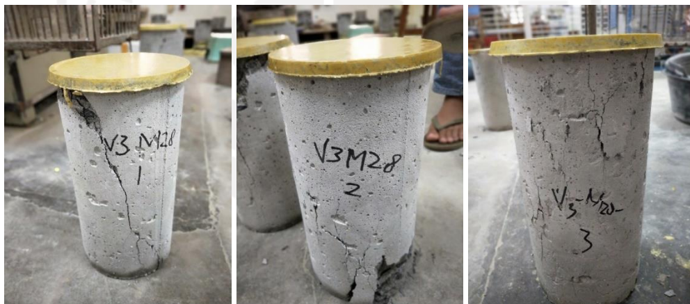
Gambar L-4.4.10 Hasil Pengujian Modulus Elastisitas
