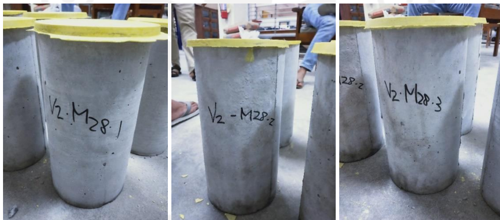
Gambar L-4.3.9 Sebelum Pengujian Modulus Elastisitas
