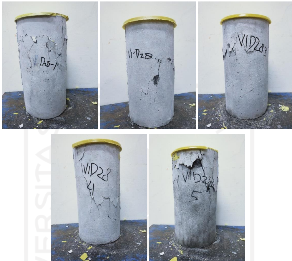
Gambar L-4.2.4 Hasil Pengujian Kuat Tekan Umur 28 Hari
