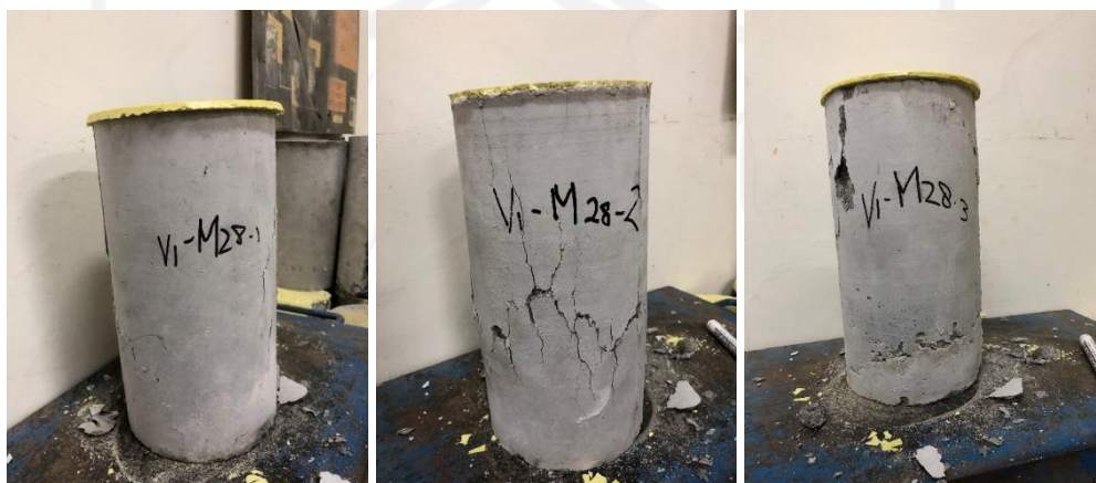
Gambar L-4.2.10 Hasil Pengujian Modulus Elastisitas
