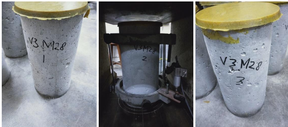
Gambar L-4.4.9 Sebelum Pengujian Modulus Elastisitas
