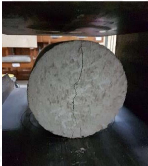
Gambar L-3.8 Proses Pengujian Kuat Tarik Belah Beton
