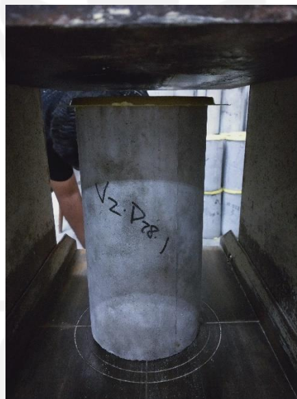
Gambar L-3.4 Proses Pengujian Kuat Tekan Beton
