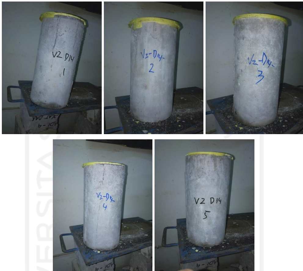
Gambar L-4.3.2 Hasil Pengujian Kuat Tekan Umur 14 Hari
