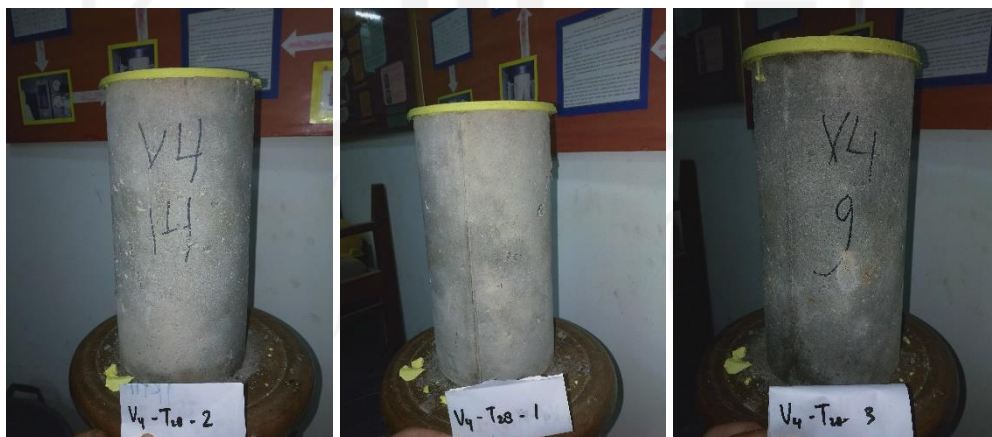
Gambar L-4.1.5 Sebelum Pengujian Kuat Tarik
