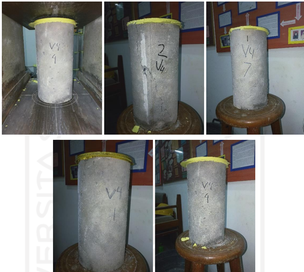
Gambar L-4.1.4 Hasil Pengujian Kuat Tekan Umur 28 Hari
