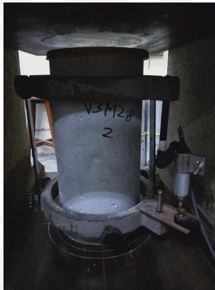
Gambar L-3.6 Proses Pengujian Modulus Elastisitas Beton
