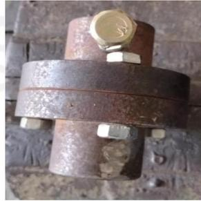
Gambar 4. 3 Kopling penyambung poros motor dan poros *bearing*
