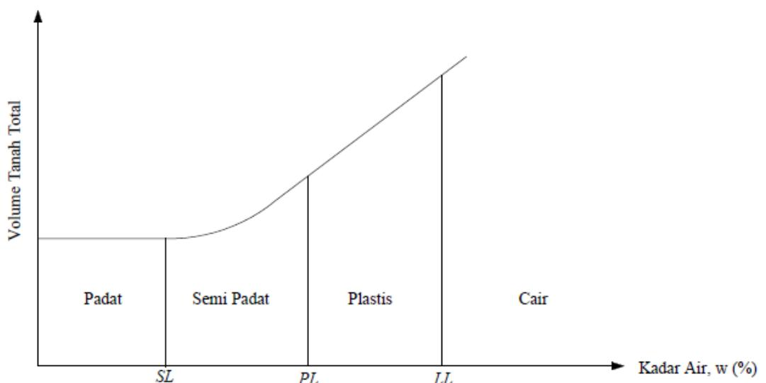
**Gambar 3.1 Variasi Volume dan kadar air pada kedudukan batas cair, batas plastis, dan batas susut**
