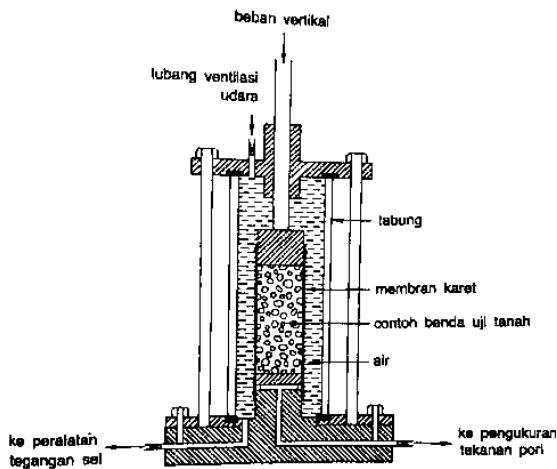
**Gambar 3.5 Skema Pengujian Triaksial UU**
