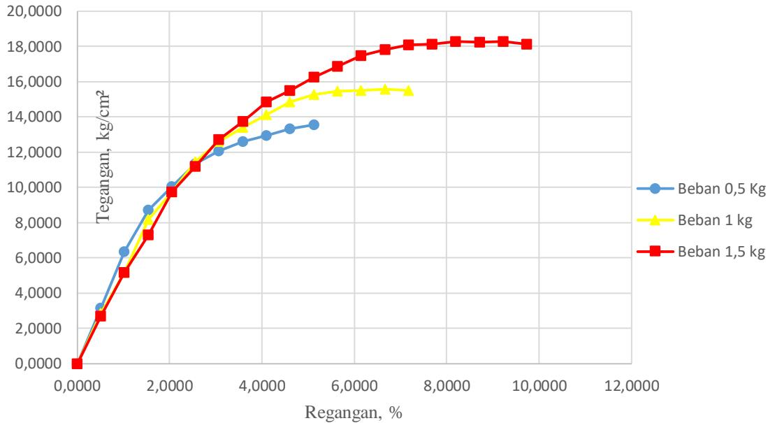
**Gambar 5.7 Grafik Tegangan-Regangan Triaksial UU Tanah Asli**
