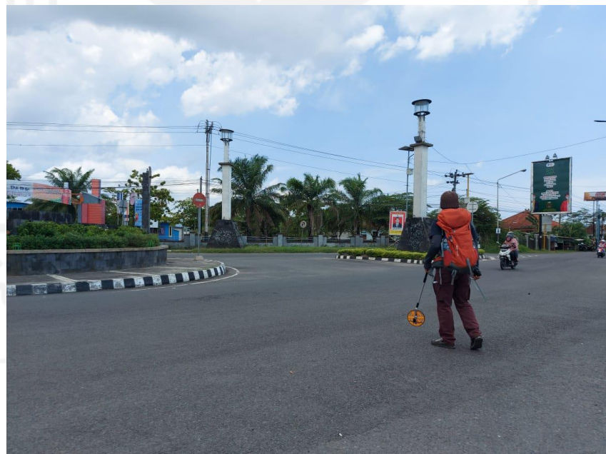
Gambar L-3.2 Pengukuran Panjang Jalan, Lebar Jalan dan Pengukuran Kerusakan dengan Rolling Measure Wheel
