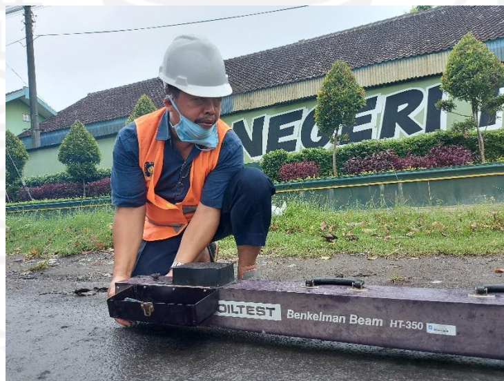
Gambar 4.4 Mengatur Benkelman Beam dalam Keadaan Datar
