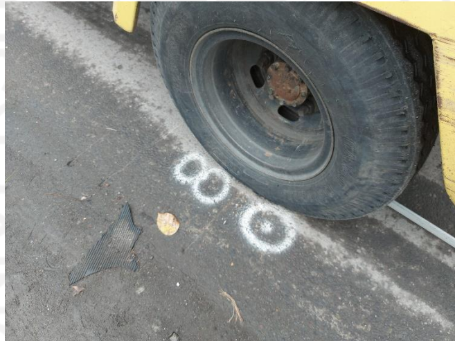
Gambar 4.2 Memusatkan Salah Satu Ban pada Titik Pengujian
