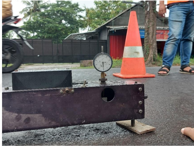
Gambar 4.5 Mengatur Arloji Pengukur
