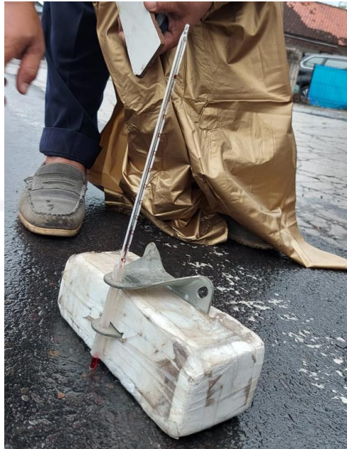
Gambar 4.6 Pemeriksaan Suhu Permukaan Jalan
