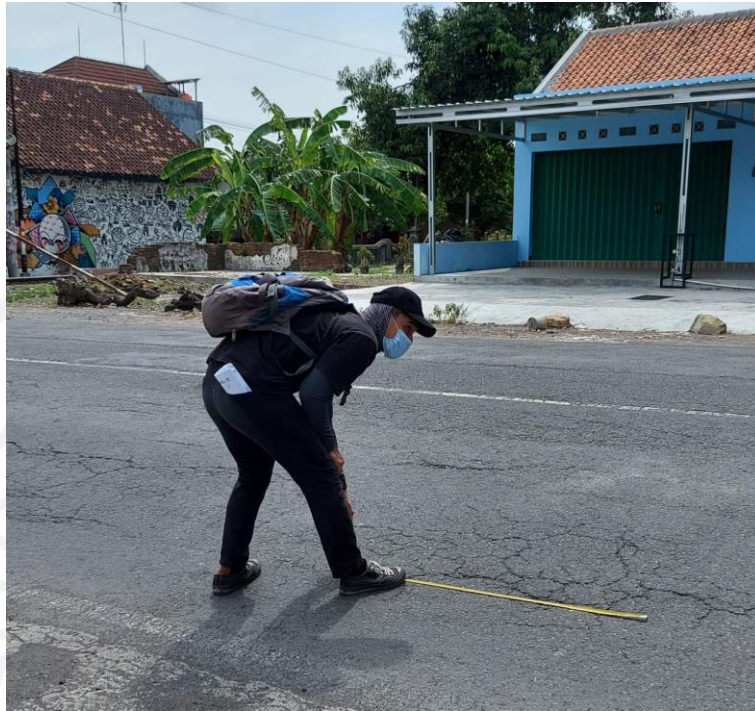
Gambar L-3.3 Pengukuran Kerusakan dengan Meteran
