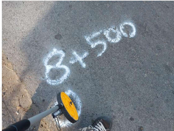
Gambar 4.1 Contoh Titik Pengujian Benkelman Beam
