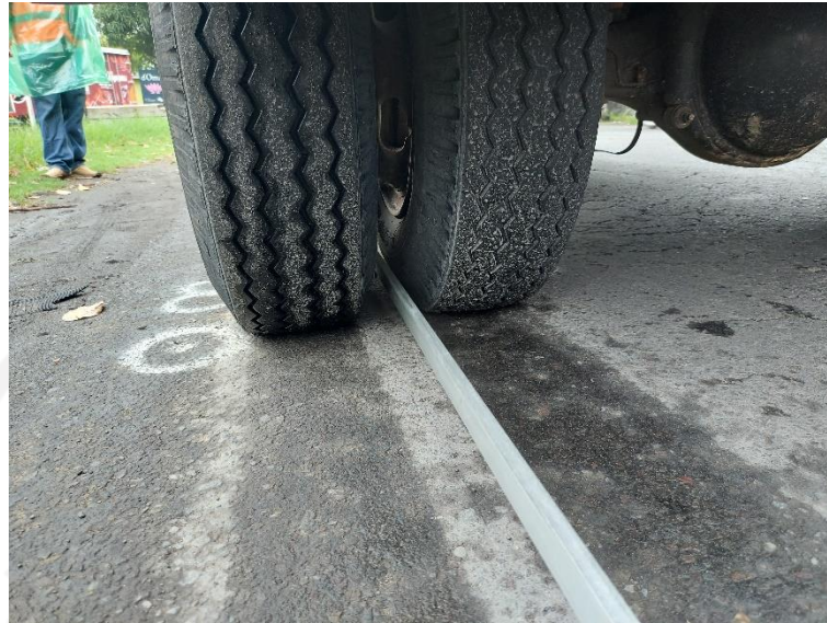
Gambar 4.3 Menempatkan Beam Toe di Tengah Ban Ganda
