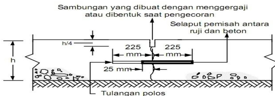
Gambar 3.10 Sambungan Susut Melintang dengan Ruji
