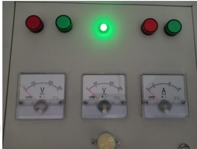
Gambar 5.9 Pengujian indikator starting dan buzzer
