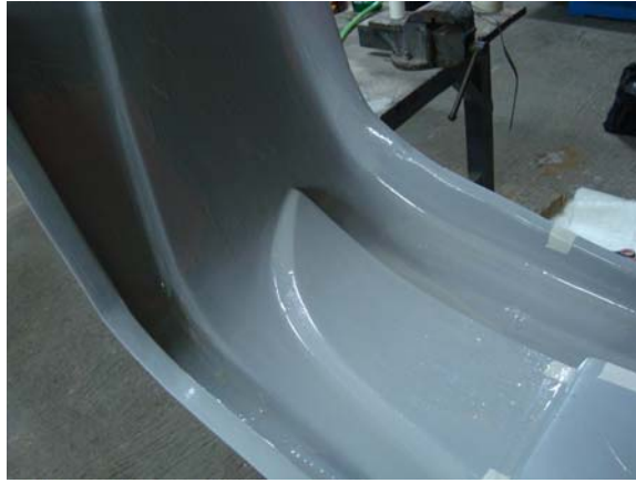
Gambar 4.15 Moulding dengan rapsian resin
