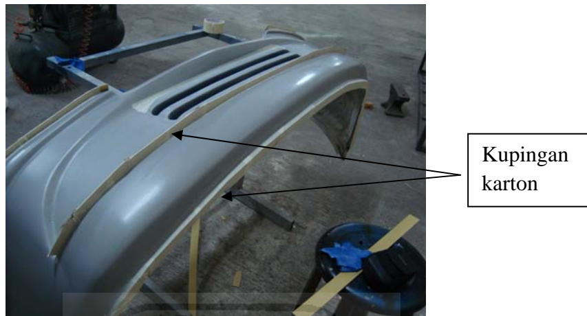
Gambar 4.7 Master moulding yang telah diberi MAA
