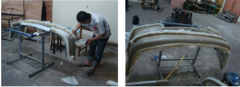
Gambar 4.8 Proses Pelapisan serat
