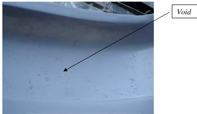
Gambar 4.22 Void pada cetakan
