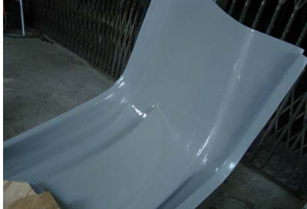
Gambar 4.10 Moulding dengan lapisan resin
