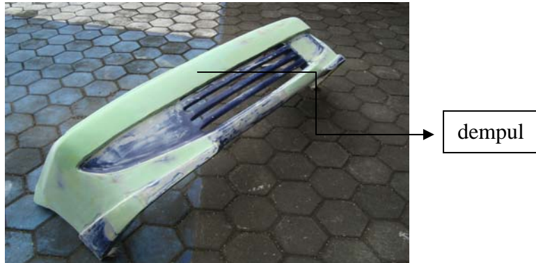
Gambar 4.5 Bumper yang telah dimodifikasi
