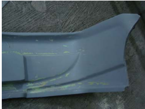
Gambar 4.24 Epoxy terlepas dari cetakan
