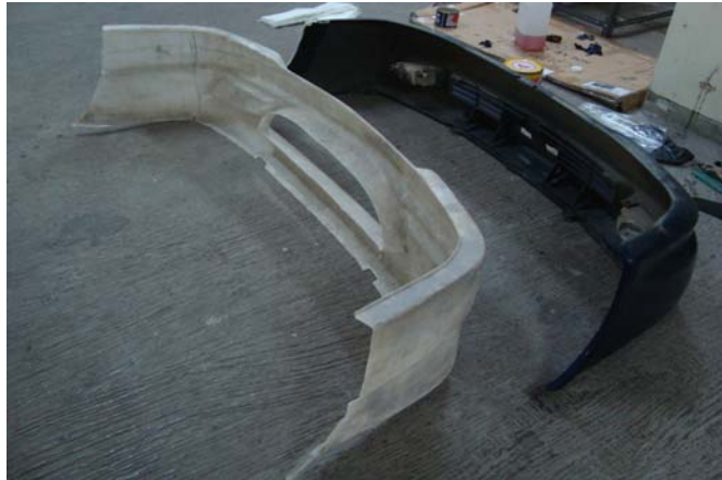
Gambar 4.3 Bumper yang telah dicetak dari bumper standar
