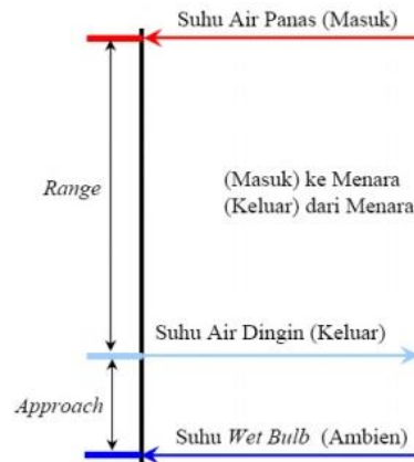
Gambar 2.2 Range dan approach temperatur pada cooling tower
