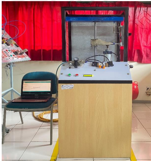
Gambar 4-35 Alat uji Dorsiflexion dan Hysteresis telapak kaki palsu
