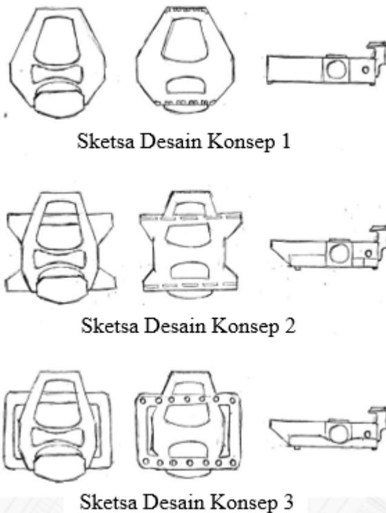
Gambar 4-1 Sketsa Desain Konsep Pedal Dua Sisi
