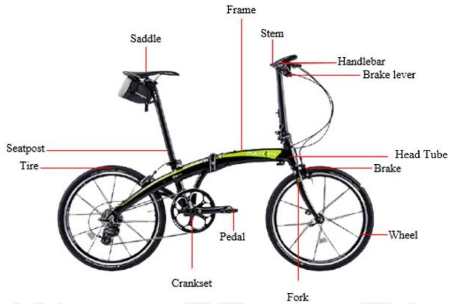
Gambar 2-2 Komponen-Komponen Sepeda
