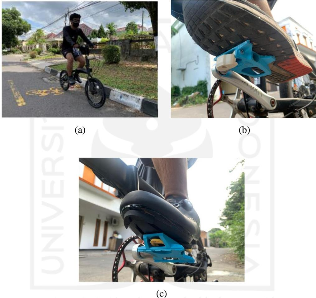
Gambar 4-9 a) Pengujian *Prototype* Kepada Responden; b) Pedal Dua Sisi Ketika Menggunakan Sepatu Biasa ; c) Pedal Dua Sisi Ketika Menggunakan Sepatu *Cleat*
