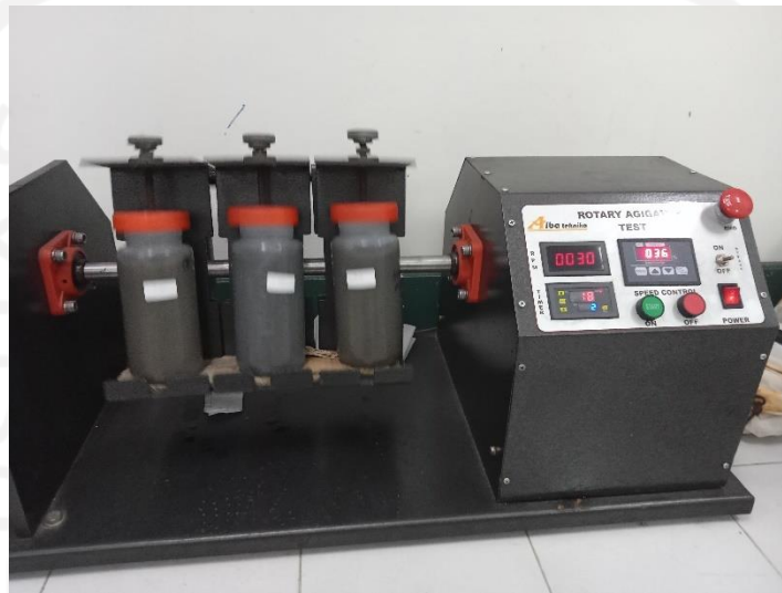
Gambar 4.5 Ekstraksi Pengujian TCLP
