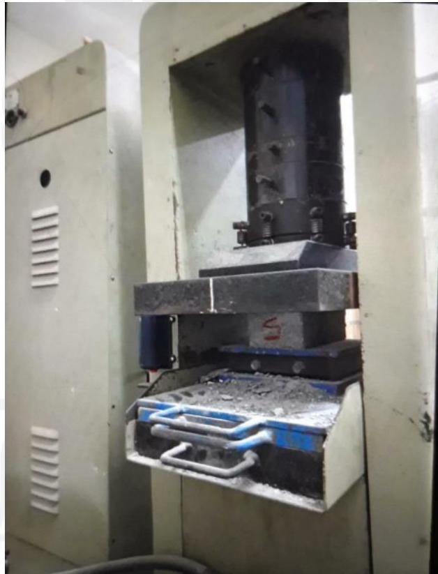
Gambar 4.1. Pengujian kuat tekan paving block
