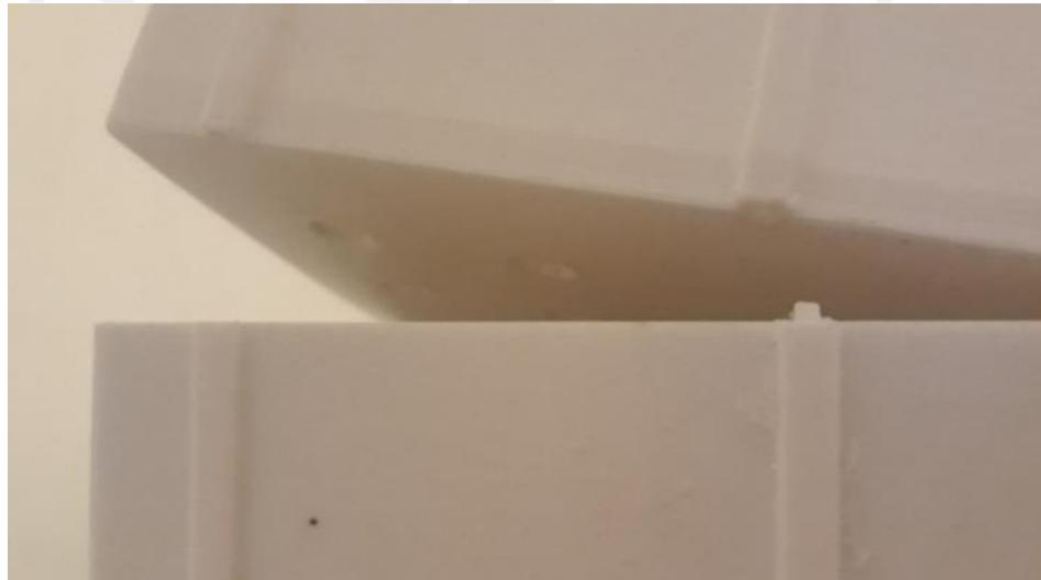
**Gambar 4.18 Sambungan Patah**
