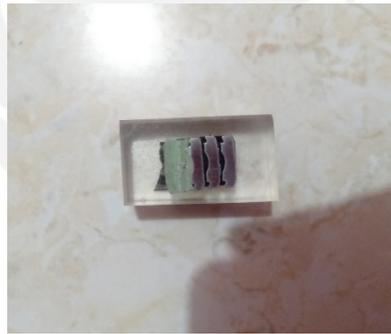
Gambar 3- 13 Spesimen Pengamatan Struktur Mikro
