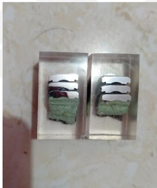
**Gambar 3- 11 Spesimen Uji Kekerasan Vickers**
