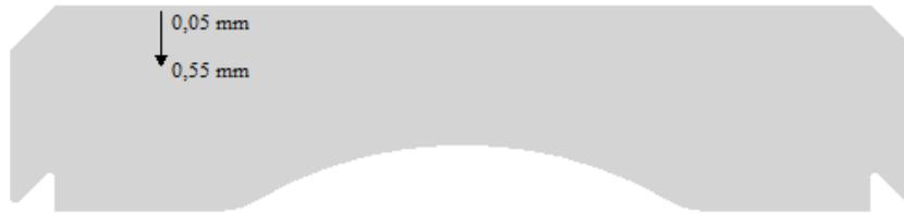
Gambar 3- 12 Pengukuran Bearing Uji Kekerasan Vickers
