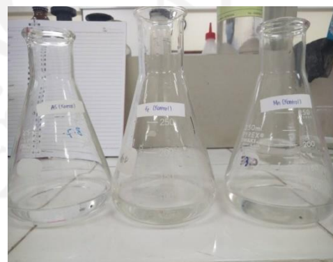
Sampel sebelum pengolahan CKD dengan (Air sumur, larutan Fe dan larutan Mn)
