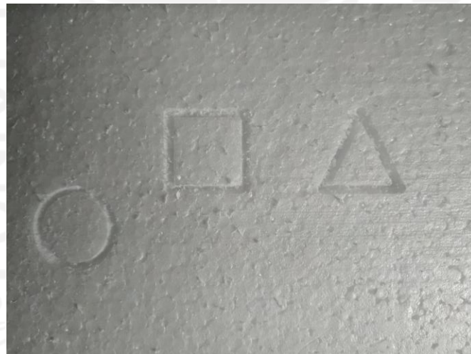
Gambar 4-20. Hasil pengujian pengiriman data ke CNC secara serial port
