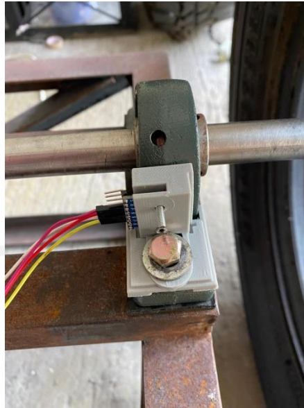
Gambar 3-5: Sensor yang terpasang pada bracket
