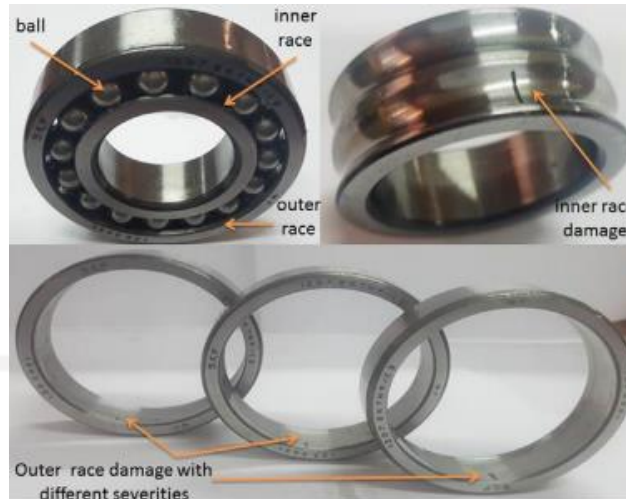
Gambar 2-2: Kerusakan pada bearing
