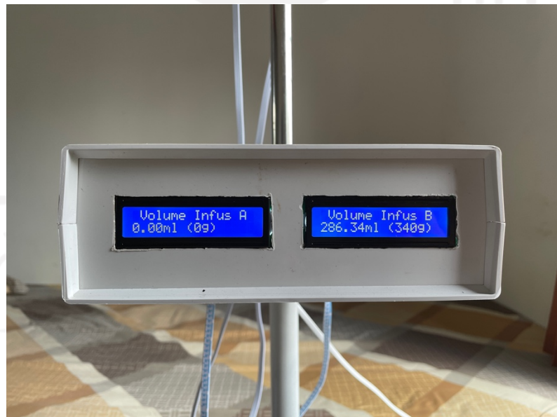
Gambar 4-13 Tampilan LCD Setelah Konversi
