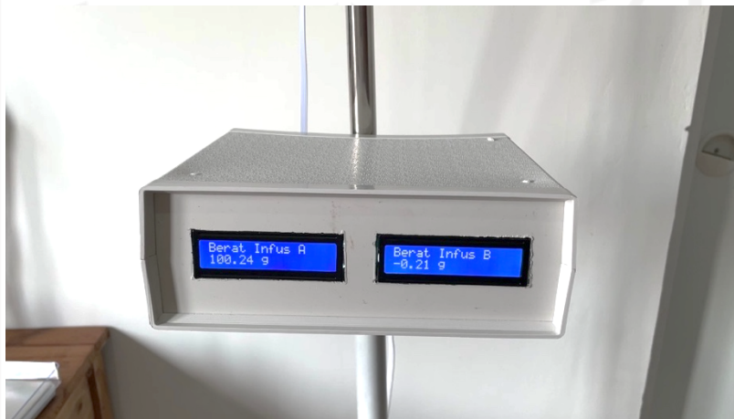
Gambar 4-5 Hasil Pengukuran Kalibrasi Load Cell A
