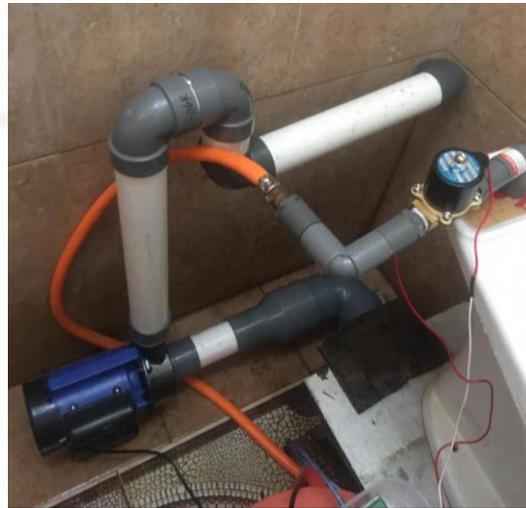
Gambar 4-26 Purwarupa dan Perpipaannya untuk Pengujian Kedua
