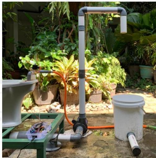
Gambar 4-14 Sistem Pembuangan berbasis *Suction*
