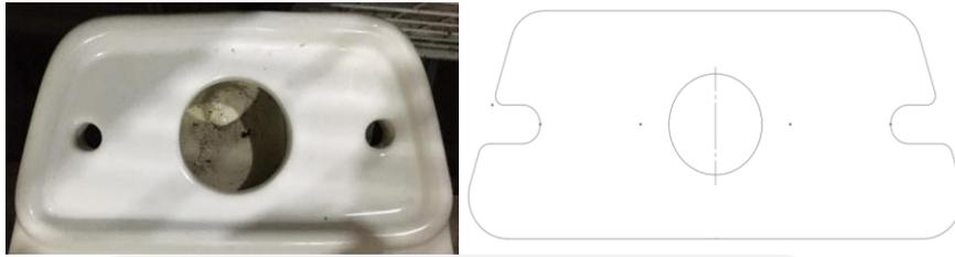
Gambar 4-15 Desain Penutup Lubang *Flush*
