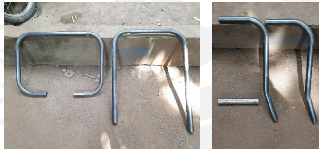
Gambar 4-11 Pembentukan Pipa Frame dan Handlebar
