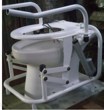
Gambar 4-17 Hasil Perakitan Produk Toilet-Seat Lifter
