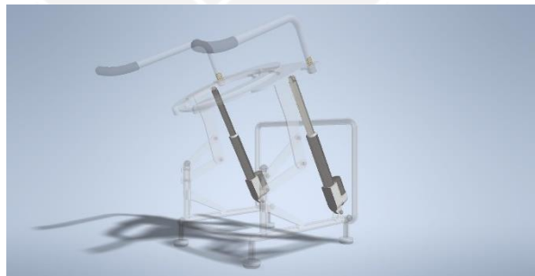
Gambar 4-9 Desain Linear Actuator pada Toilet-Seat Lifter
