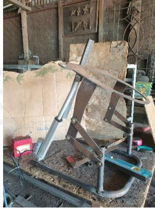
Gambar 4-14 Penyatuan Komponen dengan Pengelasan
