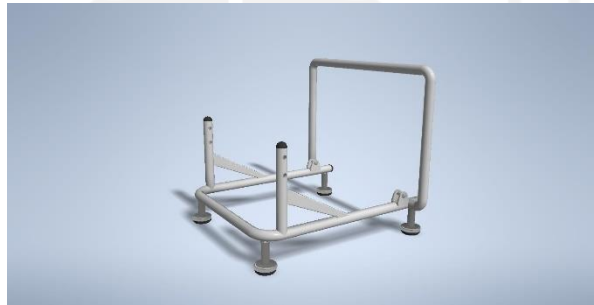
Gambar 4-7 Desain Frame pada Toilet-Seat Lifter
