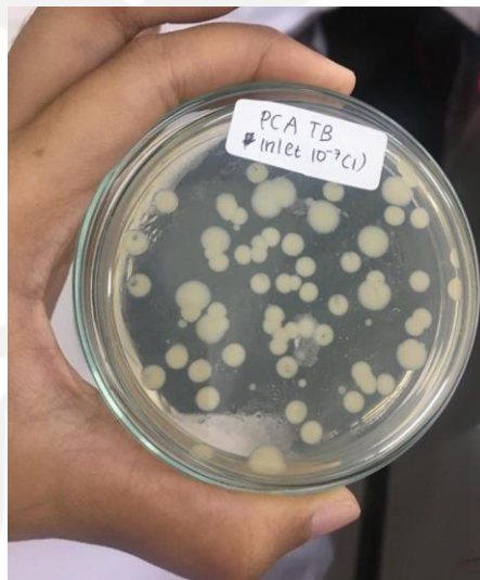
Gambar 4. 8 contoh koloni bakteri pada media PCA pada inlet IPAL Komunal Tambakrejo Bersih
