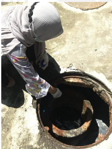
3. Mengambil sampel air dengan menurunkan botol yang sudah diikat dengan tali.
