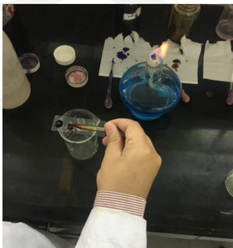
Gambar 4. 25 Proses Pewarnaan gram menggunakan 4 larutan warna
