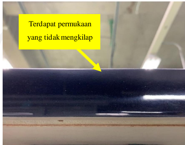
Gambar 3-7 Hasil Satu Kali Proses Buffing
