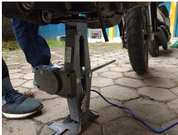
Gambar 3-3 Pengujian dongkrak elektrik yang digunakan
