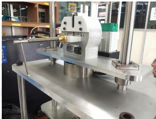
Gambar 4-2 Pemasangan load cell
