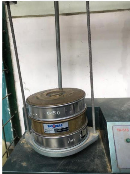
Pengayakan dengan Sieve Shaker 100 dan 200 mesh
