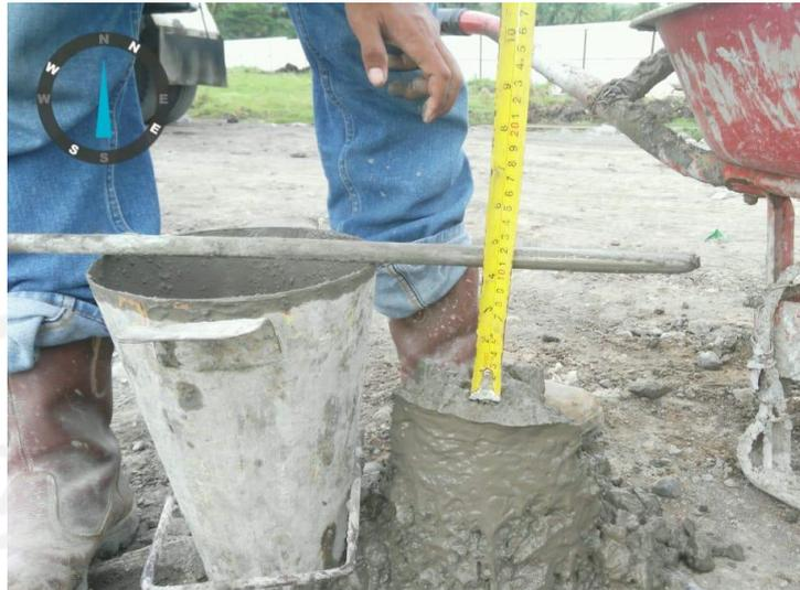
**Gambar 5.10 Uji Slump Beton**
