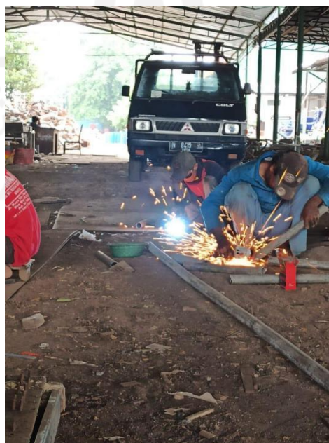
Gambar 4.2 Pemotongan besi menggunakan gerinda
