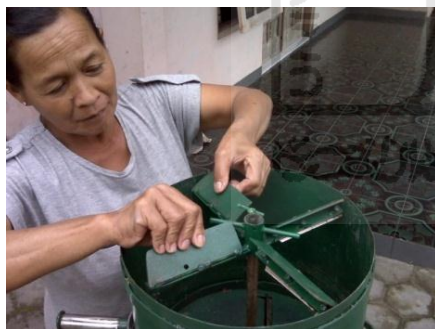
Gambar 5.5 Proses pemasangan blade
