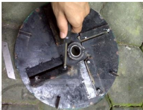
Gambar 5.4 Penggantian pisau pada konstan blade
