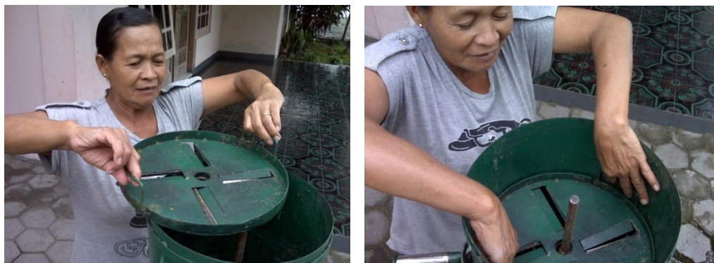
Gamabar 5.3 Cara memasang konstan blade
