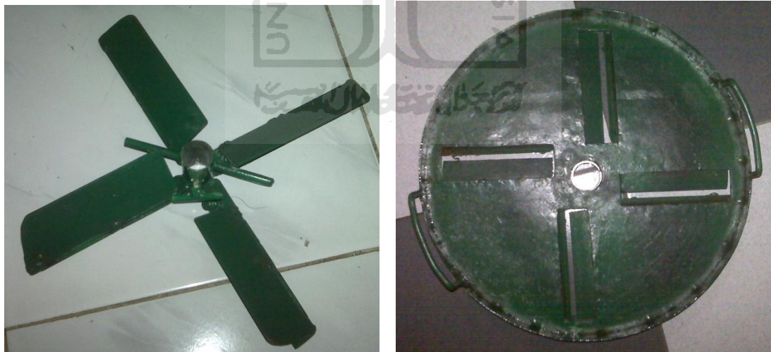
Gambar 4.9 Sebelah Kiri adalah Blade dan Sebelah Kanan adalah Konstan Blade
