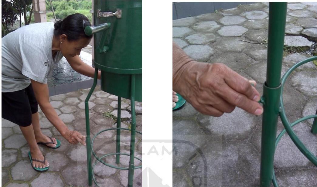
Gambar 5.10 Menyetel tinggi kaki untuk merubah sumbu poros handle putar
