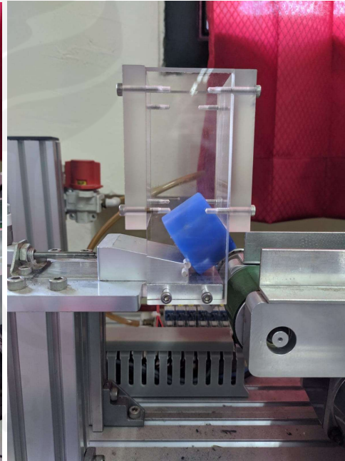
Gambar 4.17 Barang yang terdorong silinder tersangkut pada bagian penempatan
