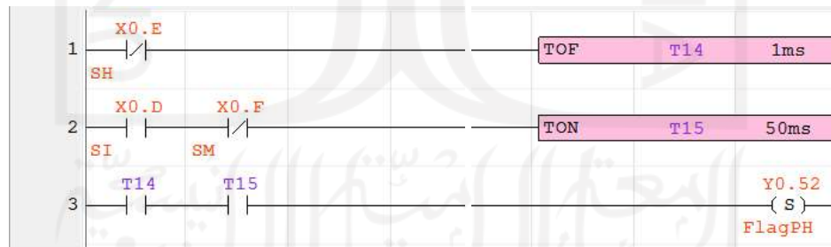
Gambar 4.8 Ladder Diagram pada flag produk jadi berbahan plastik
