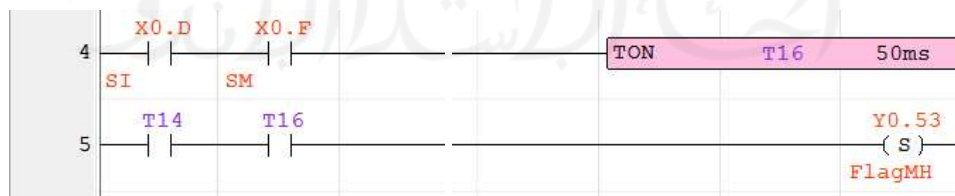
Gambar 4.10 Ladder Diagram pada flag produk jadi berbahan metal
