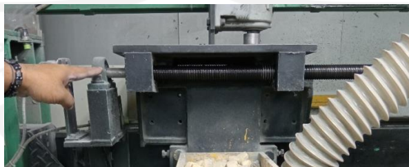
Gambar 3. 2 Ball screw kondisi saat ini
