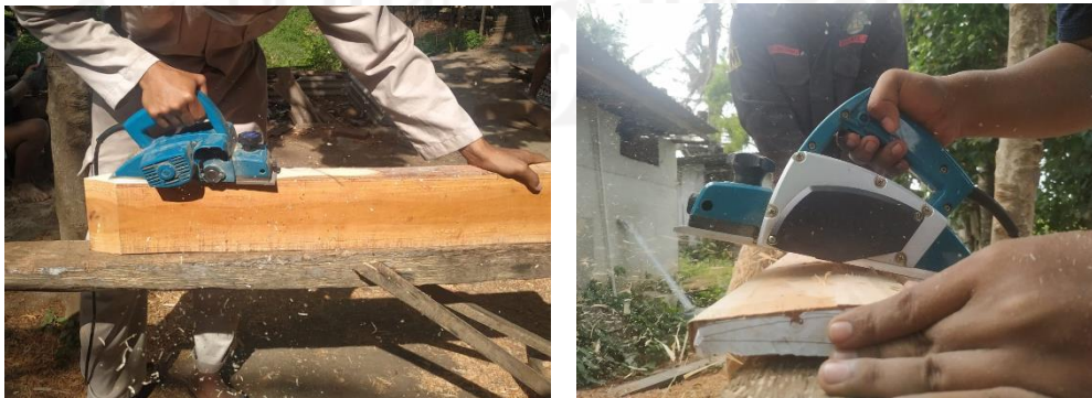
Gambar 3-8 Proses Pengetaman Kayu
