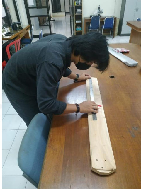
Gambar 4-1 Proses Pemberian Garis Tengah dan Titik
