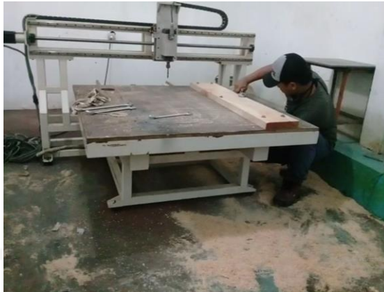
Gambar 3-22 Proses Pemasangan Klem pada Material
