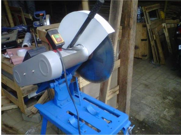
**Gambar 4- 1 mesin pemotong bambu**
