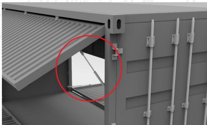
**Gambar 4- 17 Gas Spring terpasang pada bagian pintu**
