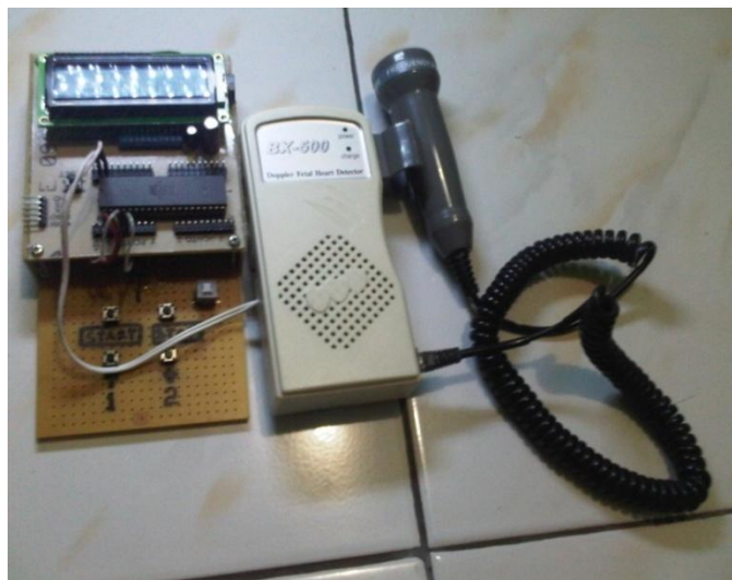
Gambar 3.4 Fetal Doppler dengan tampilan LCD
