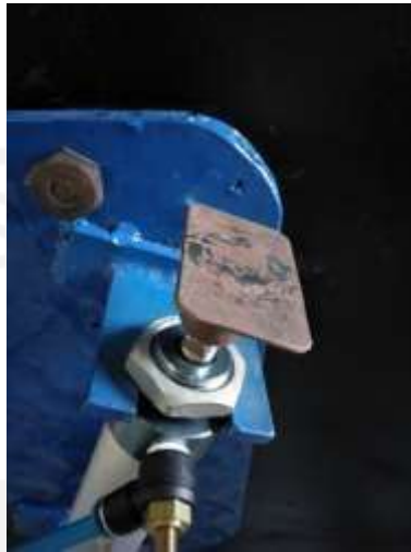
Gambar 4 - 13 Pemasangan plat penekan depan
