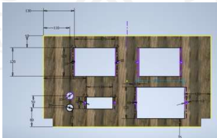
Gambar 3 - 23 Dimensi lubang-lubang pada meja kayu
