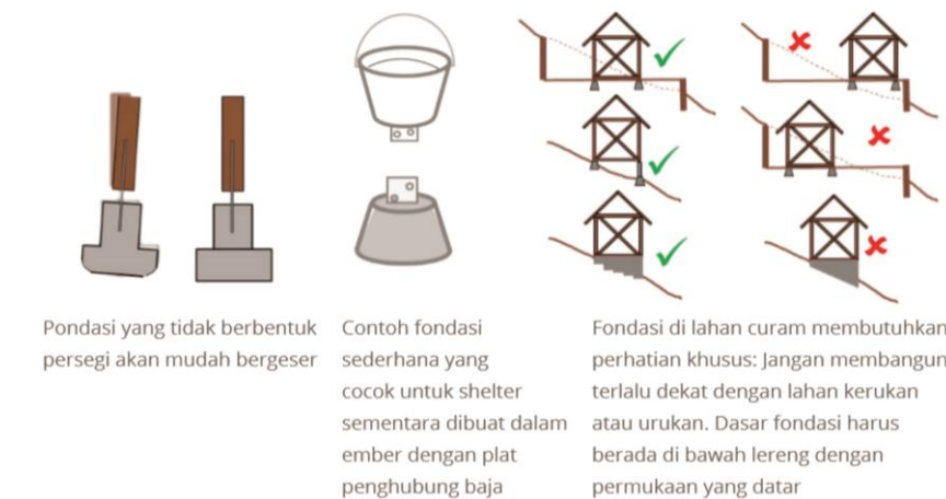
Gambar 19. Contoh pondasi sederhana pada hantara Sumber : Panduan Shelter Kemanusiaan, 2019
