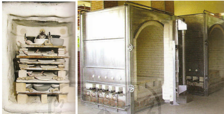
Gambar 2.42. Proses Pembakaran dengan Menggunakan Tungku Besi
