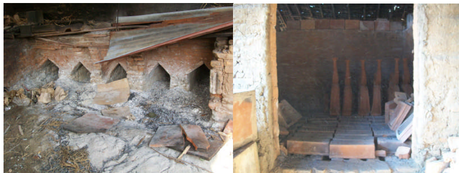
Gambar 2.41. Proses Pembakaran dengan Menggunakan Tungku Bata
