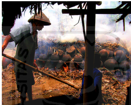
Gambar 2.40. Proses Pembakaran dengan Menggunakan Tungku Ladang
