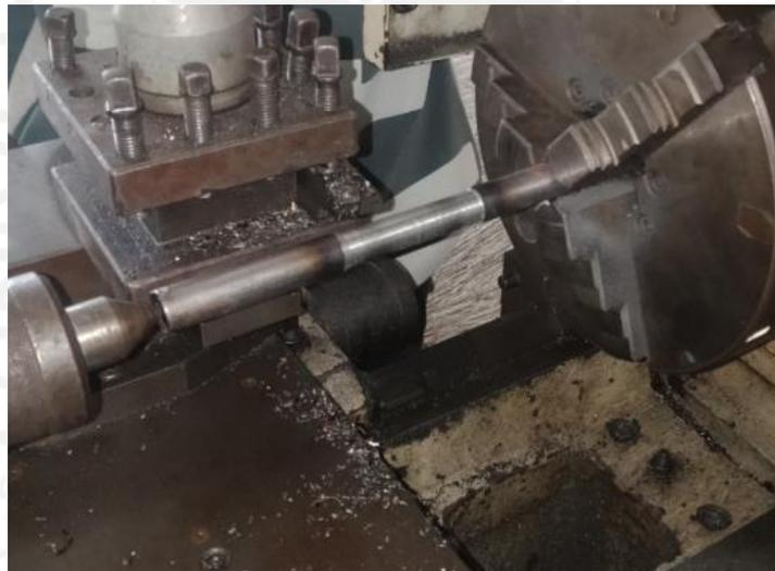
Gambar 3.5 Proses Pembuatan Spesimen Uji Tarik
