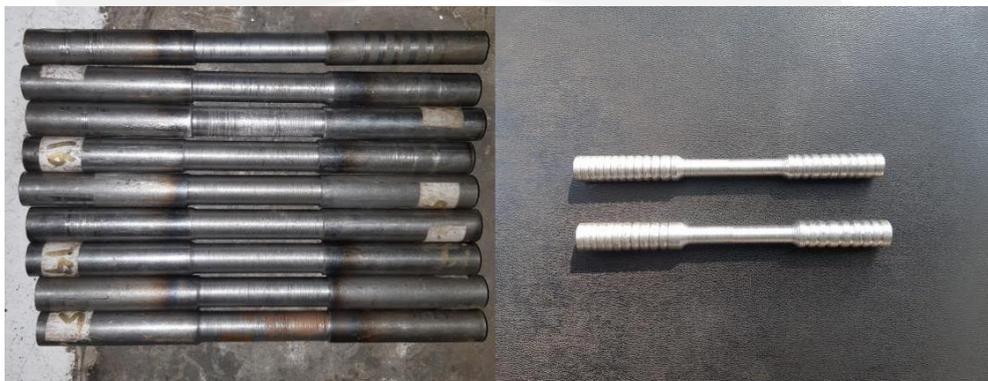
Gambar 3.10 Spesimen Uji Tarik
