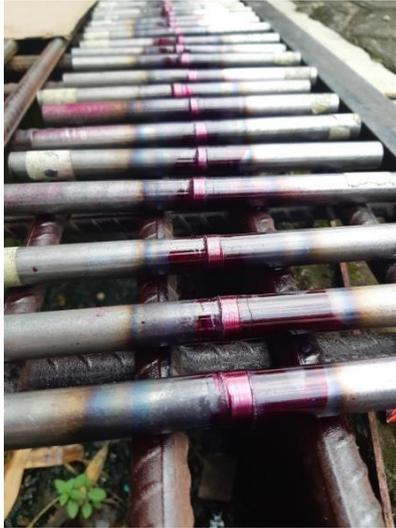
Gambar 3.9 Pengujian *Penetrant*
