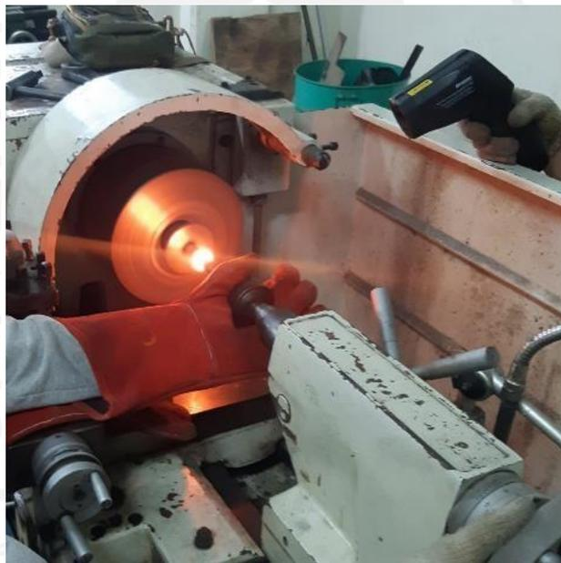
Gambar 3.3 Proses Pengelasan
