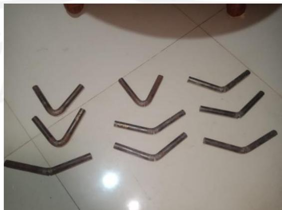
Gambar 4.11 Lengkungan Spesimen Pengujian *Bending*
