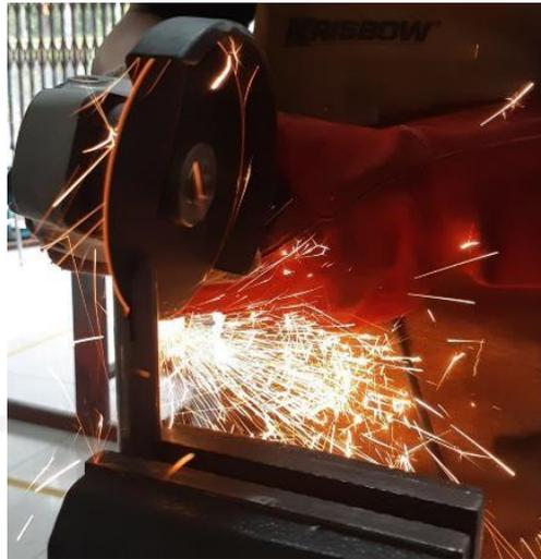
Gambar 3.6 Pembuatan Spesimen Uji Kekerasan, Komposisi, dan Mikrostruktur.
