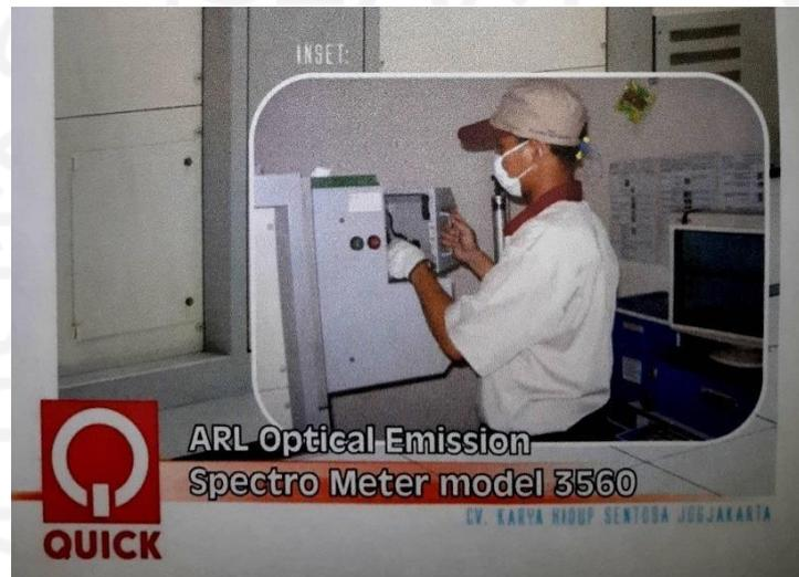
Gambar 3.8 Pengujian Komposisi
