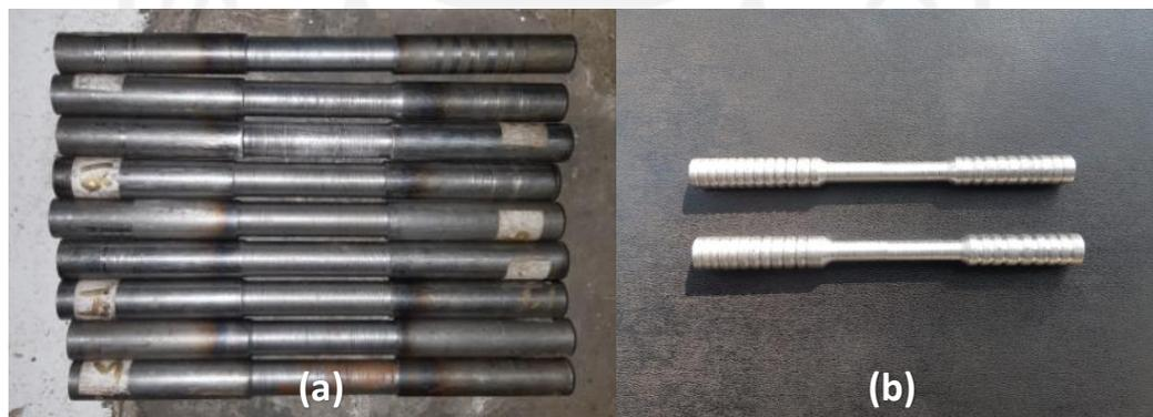
Gambar 3-10 : Hasil Pembuatan Spesimen Pengujian Tarik
