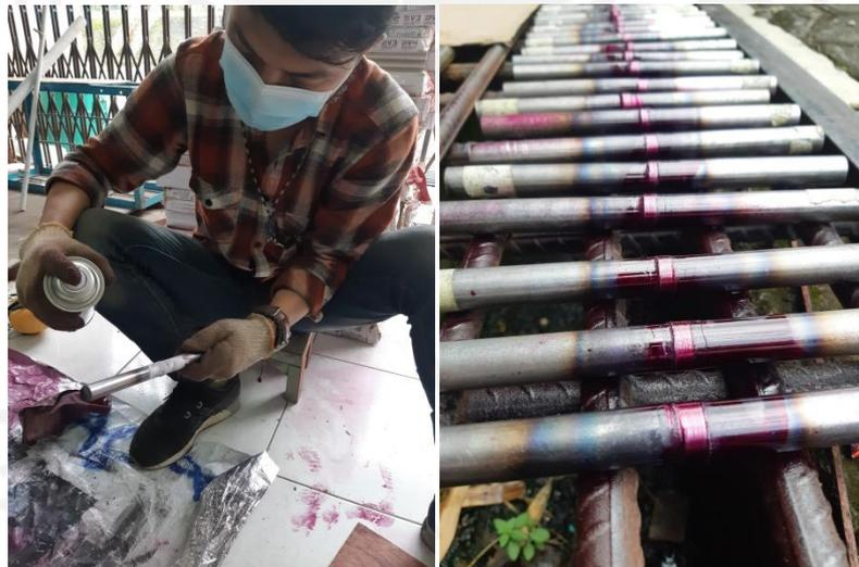
Gambar 3-6 : Proses Penyemprotan *Dye Penetrant*
