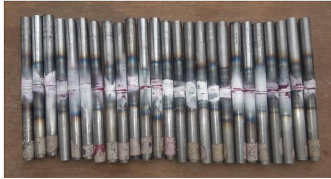
Gambar 4-3 : Hasil Pengujian *Dye Penetrant*
