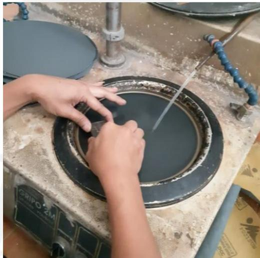
Gambar 3-14 : Proses Pengamplasan Dengan Mesin Gripo 2M
