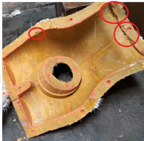
Gambar 4-3 Penampakan kerusakan pada cetakan
