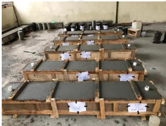
GAMBAR 21 BALOK BETON SEBELUM MENGERSAS
