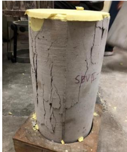
GAMBAR 32 SAMPEL SILINDER KONTROL SETELAH PENGUJIAN
