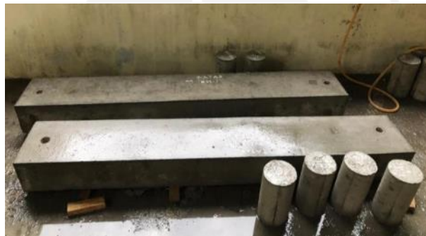
GAMBAR 24 BALOK BETON DAN SILINDER KONTROL SETELAH DILEPAS DARI BEKISTING
