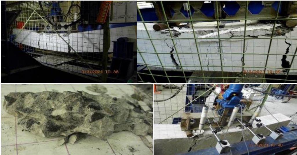
Gambar 5. 4 Benda Uji Balok Kontrol 1
