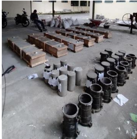
GAMBAR 23 PEMBUKAAN BEKISTING BALOK BETON DAN SILINDER KONTROL
