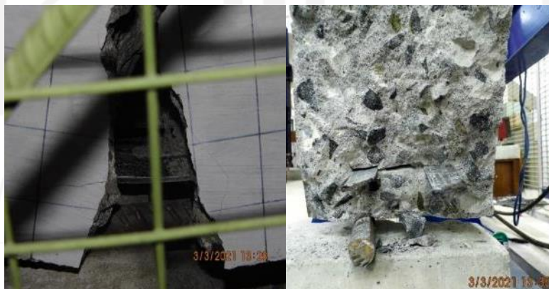
Gambar 5. 13 Keruntuhan dan Detail Melintang Balok Variasi I - 1
