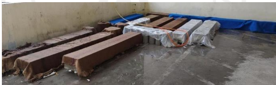
GAMBAR 25 PERAWATAN BALOK BETON DAN SILINDER KONTROL
