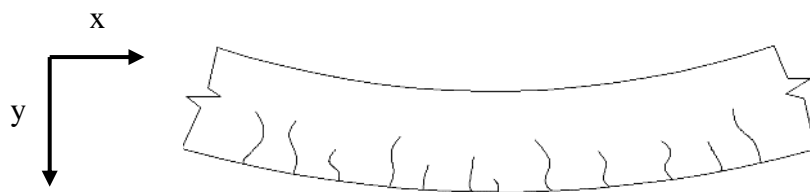
Gambar 3. 4 Perubahan Bentuk Balok Arah Y
