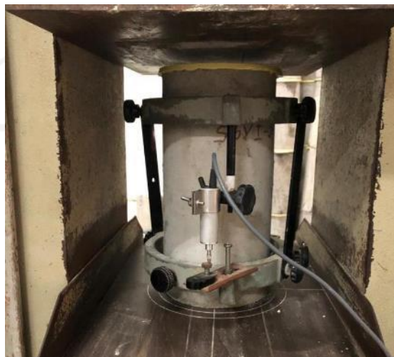
GAMBAR 31 PENGUJIAN KUAT DESAK SILINDER KONTROL
