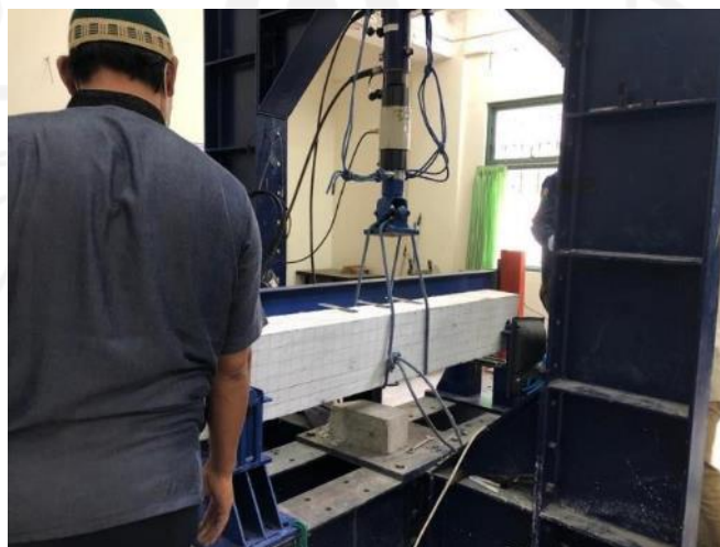
GAMBAR 34 PENGUJIAN BERAT BALOK BETON
