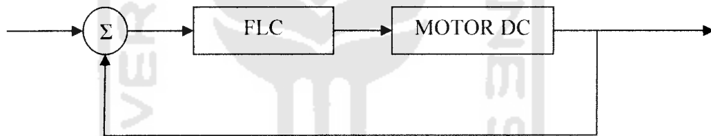
Gambar 3.1 Blok diagram sistem pengendali kecepatan motor DC
