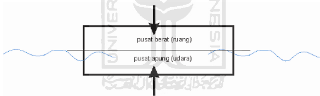
Gambar III.15 Penempatan pusat berat dan pusat apung bangunan
