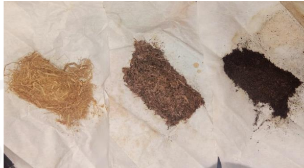
Gambar 3.1. Sampel tanpa hidrolisis, hidrolisis 1 jam, dan hidrolisis 2 jam
