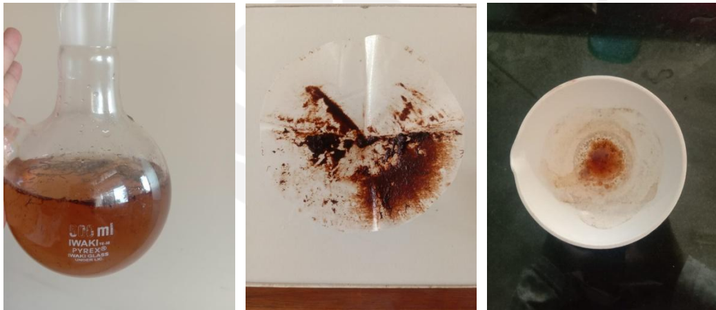
Gambar 3.5. Uji kadar lignin metode klason
