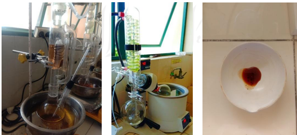
Gambar 3.3. Uji kadar zat ekstraktif
