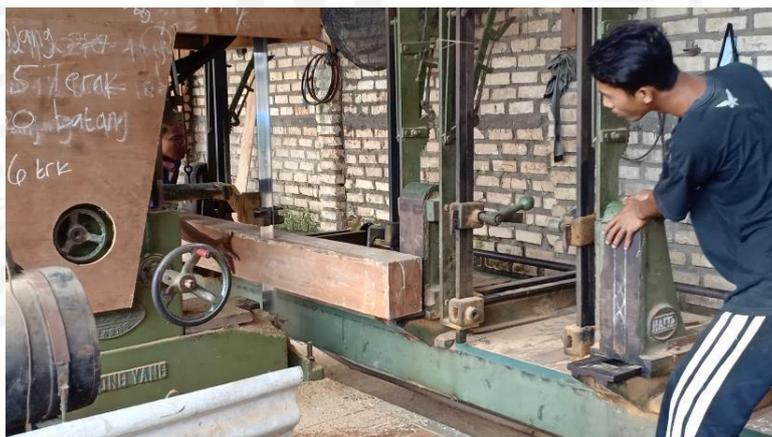
Gambar 4. 3. Proses pemotongan kayu balok
