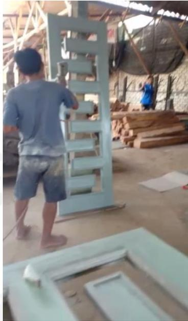
Gambar 4. 12. Proses mengecat produk
