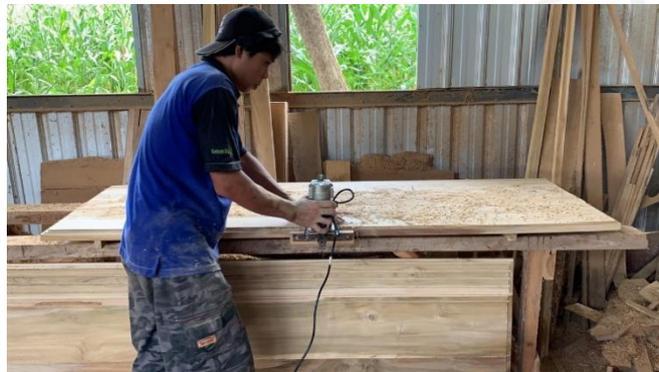
Gambar 4. 8. Proses pembuatan pinggiran atau profil
