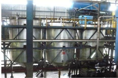
Gambar 17. Sludge Tank dan Oil Tank
